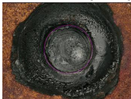
Figure 10 : Tête d'électrode en couleurs réelles, insert magenta.
