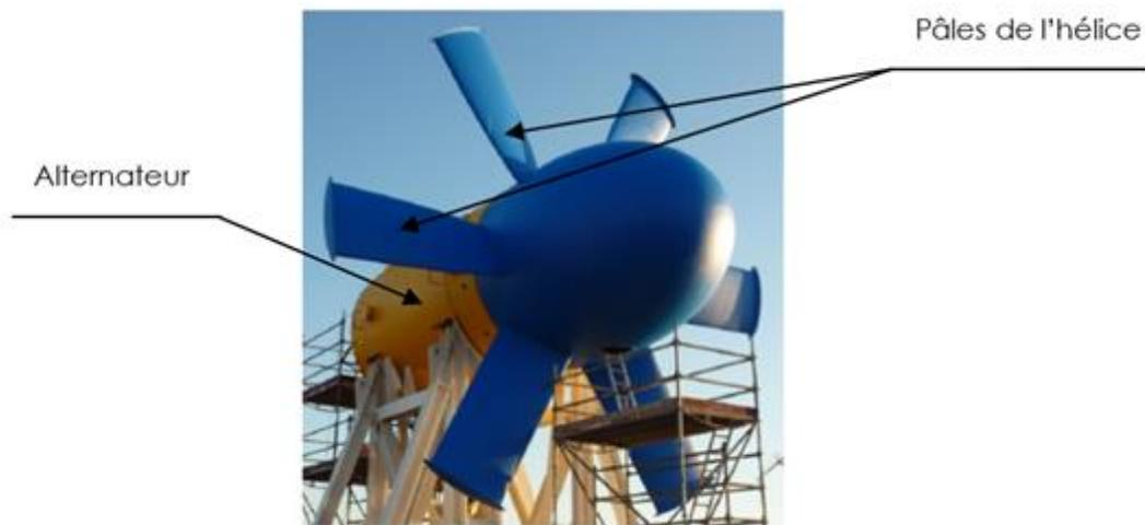
**Figure 1 :** Hydrolienne D10 développée et construite par la SAS SABELLA [12].
