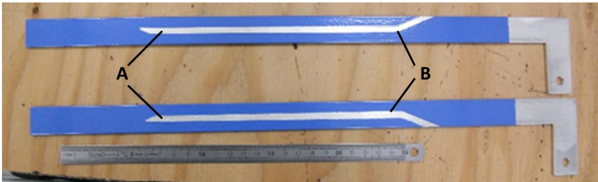
Figure 2. Photographie des barres en aluminium de 3 mm, recouvertes de 100 \mu\text{m} d'époxy. Les barres sont placées face à face. Un brin d'étain de 1,3 mm et de 1,5 \text{mm}^2 de section est placé en bout de barre sur la partie à nue (points B sur la Figure 2) pour amorcer la décharge. Les barres sont placées en V pour favoriser la propagation de l'arc vers l'extrémité des barres.
