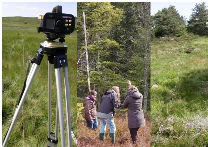
Figure 2 – Mise en place d'un PSET sur le terrain. De gauche à droite : niveau laser pour mesurer la distance entre chaque segment ; mire à code barre pour mesurer la hauteur et perche métallique graduée pour mesurer la profondeur de tourbe ; corde matérialisant la toposéquence au sol.
